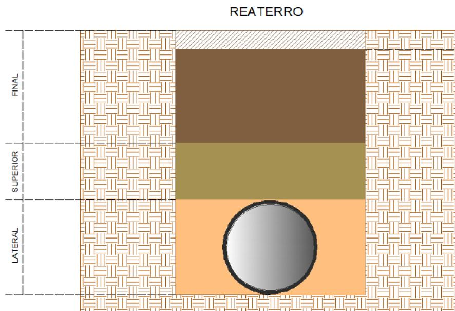
Figura 20: Camadas de reaterro conforme NBR 7367
