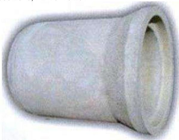
**Informações Gerais:** Tubo de concreto pré moldado, em concreto armado, com junta rígida tipo Ponta e Bolsa (PB), Classe PA 2, seção transversal circular com diâmetro de 400mm, para uso em escoamento de águas pluviais. Utiliza armadura, portanto é mais resistente a esforços provocados por veículos ou deslocamentos do solo. Utilizado em galerias e drenagem de águas pluviais em loteamentos, rodovias, aeroportos, pátios, bueiros...
