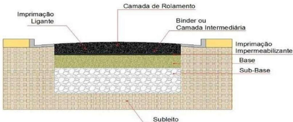
**Figura 1: Estrutura típica de um pavimento asfáltico.**
